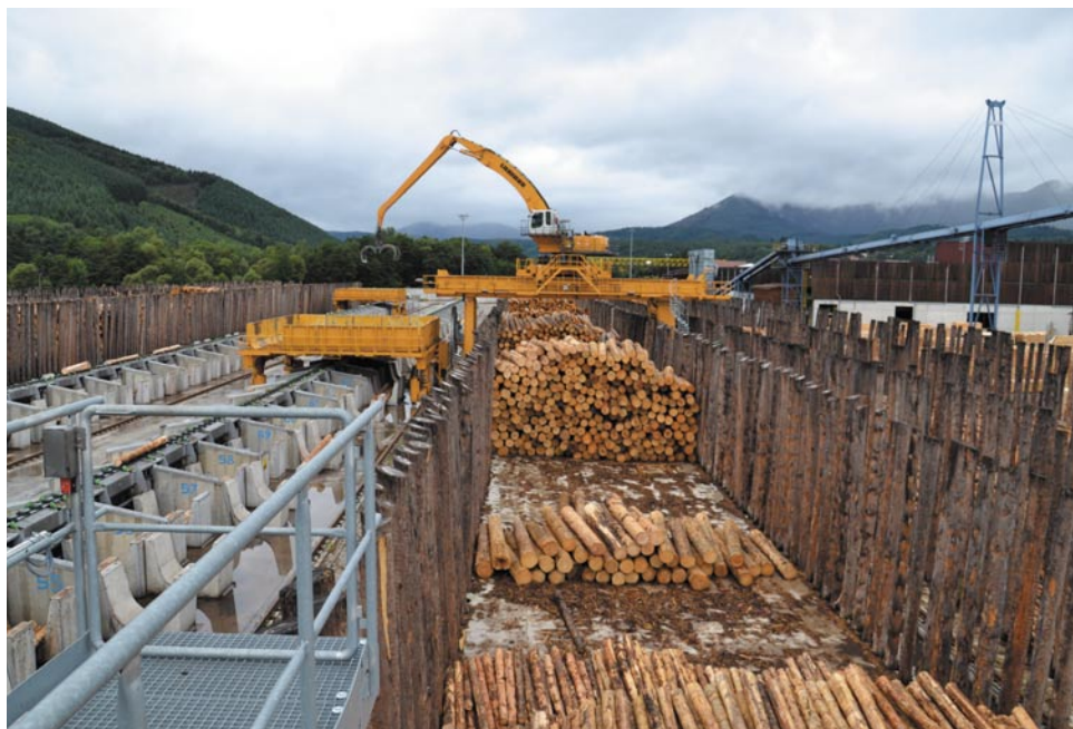
Ukládání kulatinových výřezů do boxů na pile Siat Braun. Foto: archiv SVOL
