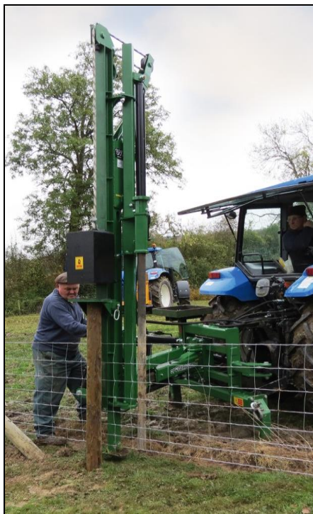
Obr. 54: Traktorový zatloukač WRAG při práci
