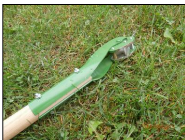
Obr. 47: Zraňovač kmenů hoblíkový (Grube KG)
