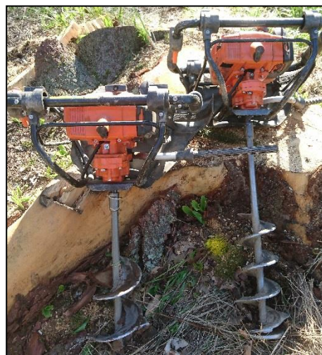
Obr. 49: Provozně odzkoušené půdní vrtáky STIHL s vrtákem o průměru 15 cm a 12 cm
