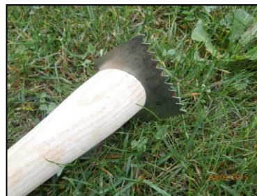
Obr. 48: Zraňovač kmenů pilový (Grube KG)
