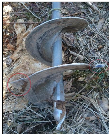
Obr. 52: Šroubovice vrtáku s navařenými výstupky z tvrdokovu
