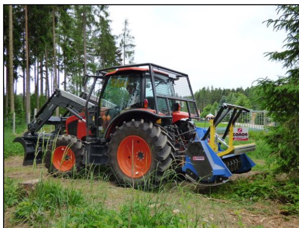
Obr. 6 : Lesní fréza (drtič klestu) ZANON TM 160 na traktoru Kubota
