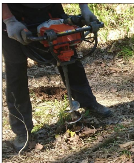
Obr. 30: Jednomužný vrták při práci
