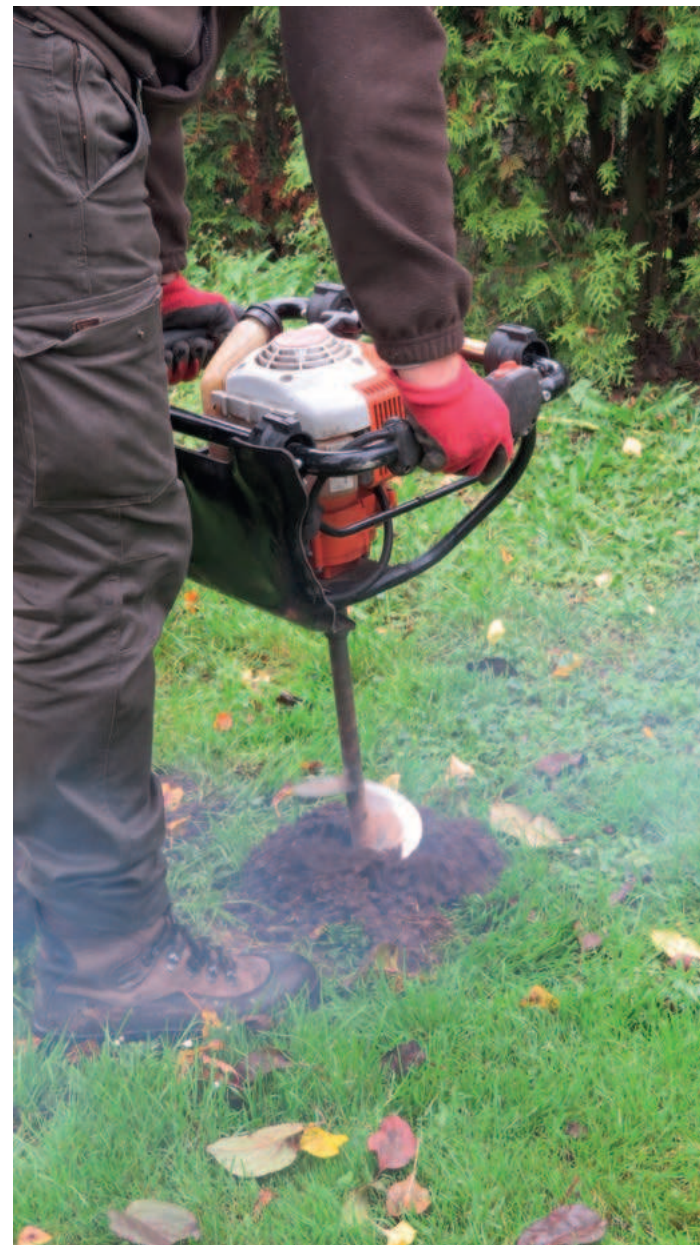
Obr. 4 Motorový jamkovač při práci
