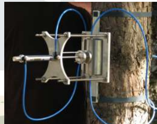
AUTOMATICKÉ MĚŘENÍ VÝDEJE CO 2 Z POVRCHU KMENE
